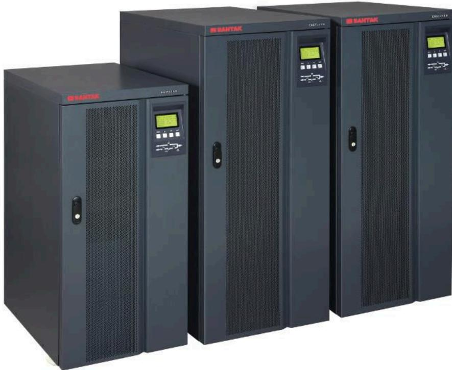
城堡 3C3 EX 系列 UPS 每一相由一个单独的 PFC 电路把交流转换成直流再经过逆变器（Inverter）将直流转换成交流输出。同时，提供一块单独的控制器，对 PFC 电路进行的实时控制和数据采集，以使整个系统更协调的运行/更及时的把系统状态反馈给用户。同时，通过对电池充电方式的控制，有效地延长了电池的使用寿命。双市电的输入结构提高了整个系统的可靠性。3C3 EX 系列产品还增加了系统的防护等级，使产品可以在灰尘较大的工业环境下稳定运行。
